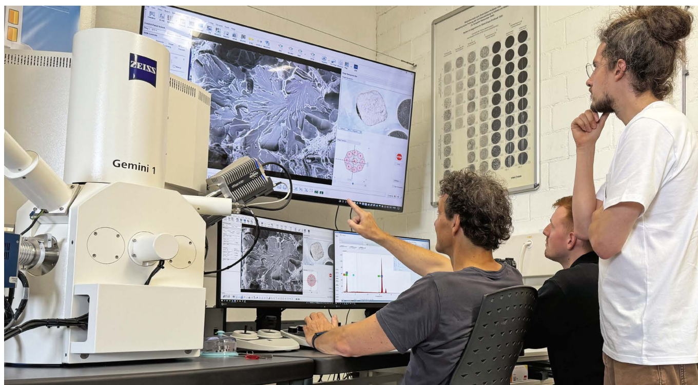
Mit dem Rasterelektronenmikroskop können am WITG Materialzusammensetzungen und Oberflächenstrukturen untersucht werden.
